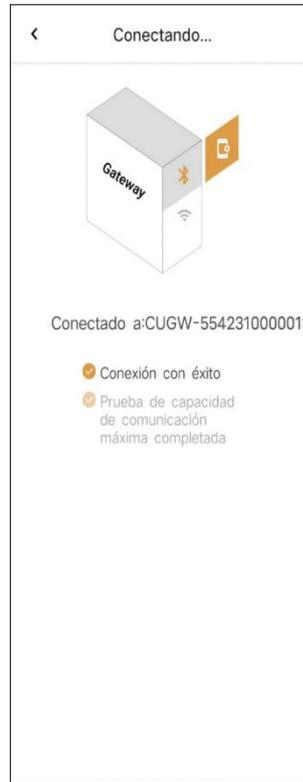
El SN de la puerta de enlace se incluye en el nombre de la señal BLE y la aplicación enumerará las señales escaneadas. Seleccione el SN consistente con la etiqueta de la puerta de enlace de destino y haga clic para ingresar.
