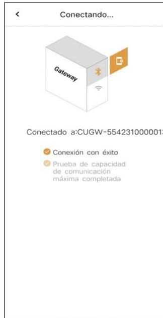
El SN de la puerta de enlace se incluye en el nombre de la señal BLE y la aplicación enumerará las señales escaneadas. Seleccione el SN consistente con la etiqueta de la puerta de enlace de destino y haga clic para ingresar.
